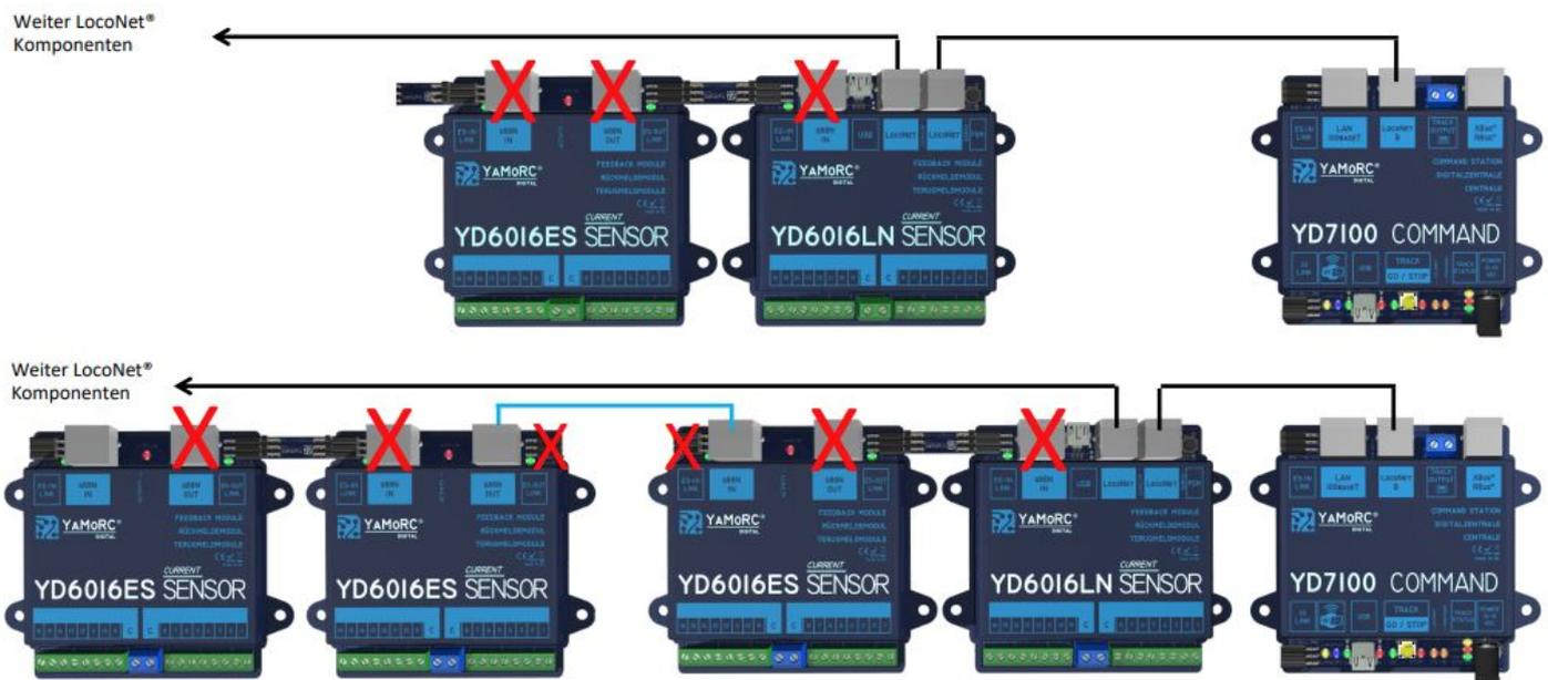
Maximalausbau: 96 Rückmelder, bestehend aus 5 Rückmeldemodule mit je 16 Eingängen im gesamten "ES-LINK"-Strang.
